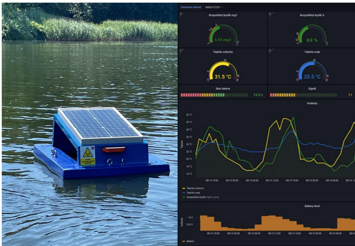
Obr. č. 4 Plovoucí automatický analyzátor rozpuštěného kyslíku ( https://www.smonox.cz/ )
